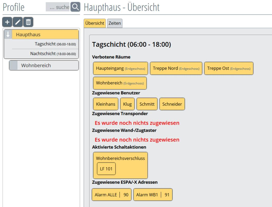
Abbildung 216: Profil Alarmschnittstellen (ESPA/-X) Übersicht
