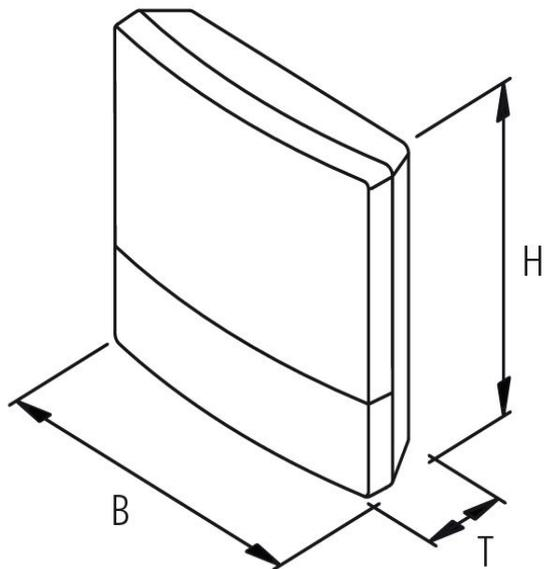
Abbildung 1: Maßzeichnung der Außenseiten (BxHxT 220mm x 220mm x 50,5mm)
