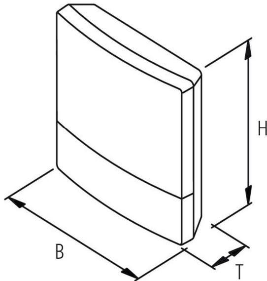
Abbildung 3 Maßzeichnung des Gehäuses Außenseiten BxHxT 220mm x 220mm x 50,5mm
